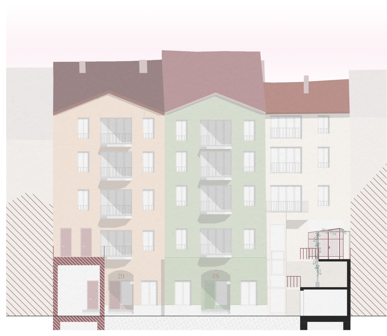
Ansicht 1:200 Innenhof Steinweg Die Innenhoffassaden 25,27,29 sind entsprechend dem Bestandsschutz gestaltet. Angemessene Fensteröffnungen zur Loggia ermöglichen ein modernes Raumgefühl im Altbauflair. Sie bieten ein qualitatives Öffnen zum Garten mit Kommunikationsmöglichkeit und direkten Blickbezug.
